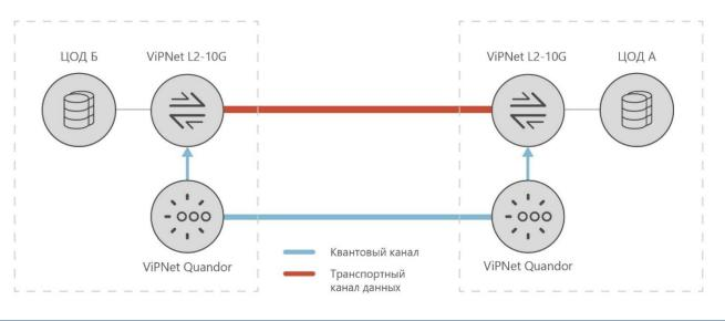
Базовый сценарий использования – автоматическая доверенная доставка криптографических ключей для канальных шифраторов ViPNet L2-10G
